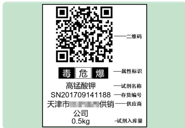
图2 危化品的二维码标签示例图
