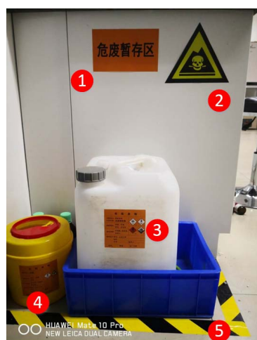
①—危废暂存区;②—危废区域三角标;③—含卤有机物危废标签; ④—利器危废标签;⑤—危废暂存区划线
